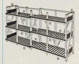
Verbindungslatten (6) auf Pfosten nageln (Nägel 70 mm<sup>2</sup>)
