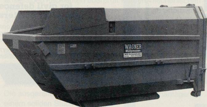
Die ideale Müllverdichtungsanlage für grossen Kehrichtanfall. Rationelle Abfuhr durch Absetz- oder Gleitabsetzkipper. Kleiner Platzbedarf, an keinen festen Standort gebunden.
