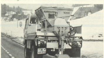
Aufsetzstreuer Ammann 1000 für Kommunalfahrzeuge Behälterinhalt 1 m³.
