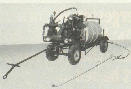
Fass-Sprengwagen für das Sprengen von Kaltemulsionen und Lackbitumen, drei Ausführungen, Systeme AMMANN und BIEL.
