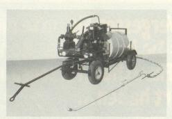
Fass-Sprengwagen für das Sprengen von Kaltemulsionen und Lackbitumen, drei Ausführungen, Systeme AMMANN und BIEL.
