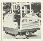
Die neue FMC-Kehrsaugmaschine, Modell Wayne 67 mit hydraulischer Hochentleerung in Grossmüllcontainer, gewährleistet eine staubfreie, wirtschaftliche Industriereinigung. Maximale Kehrbreite mit Seitenbesen 1422 mm. Schmutzbehälter-Fassungs-vermögen 663 l. Wahlweise mit Benzin-, Diesel- oder Flüssiggas-4-Zylinder-Motoren lieferbar. Hydraulische Antriebe mit stufenlos regelbaren Fahrgeschwindigkeiten bis zu 19 km/h ergeben eine maximale Kehrleistung bis zu 26 600 m² saubere Fläche pro Stunde.
