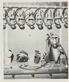
Es ist möglich, sämtliche Pressluftflaschen der 12 Atemschutzgeräte am Zug selber über eine besondere Fülleitung auf 300 bar aufzufüllen. In den Kasten der Fahrzeuge sind 800 m Feuerwehrschlauch mit den notwendigen Strahlrohren vorhanden, Luftschaumrohre für Schwer- und Mittelschaum, Rettungsleitern, Handfeuerlöscher, Pioniermaterial und Beleuchtung sowie eine tragbare Motorspritze mit mittlerer Leistung.
