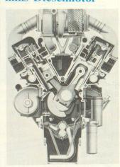
Der neue schnellaufende 16-Zylinder-Cummins-Dieselmotor Modell KTA-3067 mit 1600 PS (1194 kW) Leistung.
