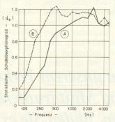
Schallabsorptionsvermögen der Siang-Schallschutzplatten: A auf Unterlage (Decke oder Wand) anliegend B mit Abstand von der Unterlage Schallabsorptionsgrad  $\alpha_s$ : im Tiefton 0,29 0,64 bereich im mittleren 0,97 1,17 Tonbereich im Hochton-1,08 1,10 bereich im gesamten 0.78 0.97 Tonbereich VSGH Vereinigung Schweizeri-scher Grossküchen-Hersteller
