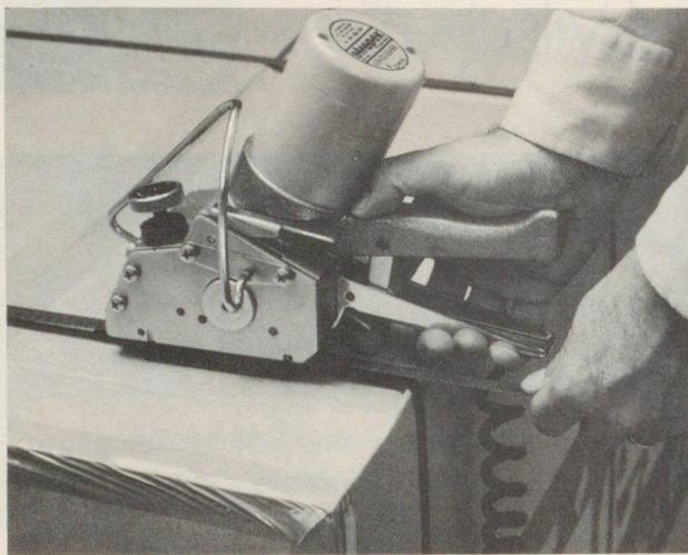
Ein treuer Helfer ist bestimmt der elektrische **strapex**-Vibro-spanner. Er arbeitet für Sie und wird nie müde. Sie brauchen blos das Kunststoff-Umreifungsband einzulegen. Die restliche Arbeit können Sie dann ruhig dem Vibro überlassen. Er spannt "wie der Blitz" und schliesst die Umreifung mit dem sichersten Schweißverschluss ab. Mühe los, schnell und ohne teure Plomben (PTT-konform). Verlangen Sie eine unverbindliche Demonstration!
