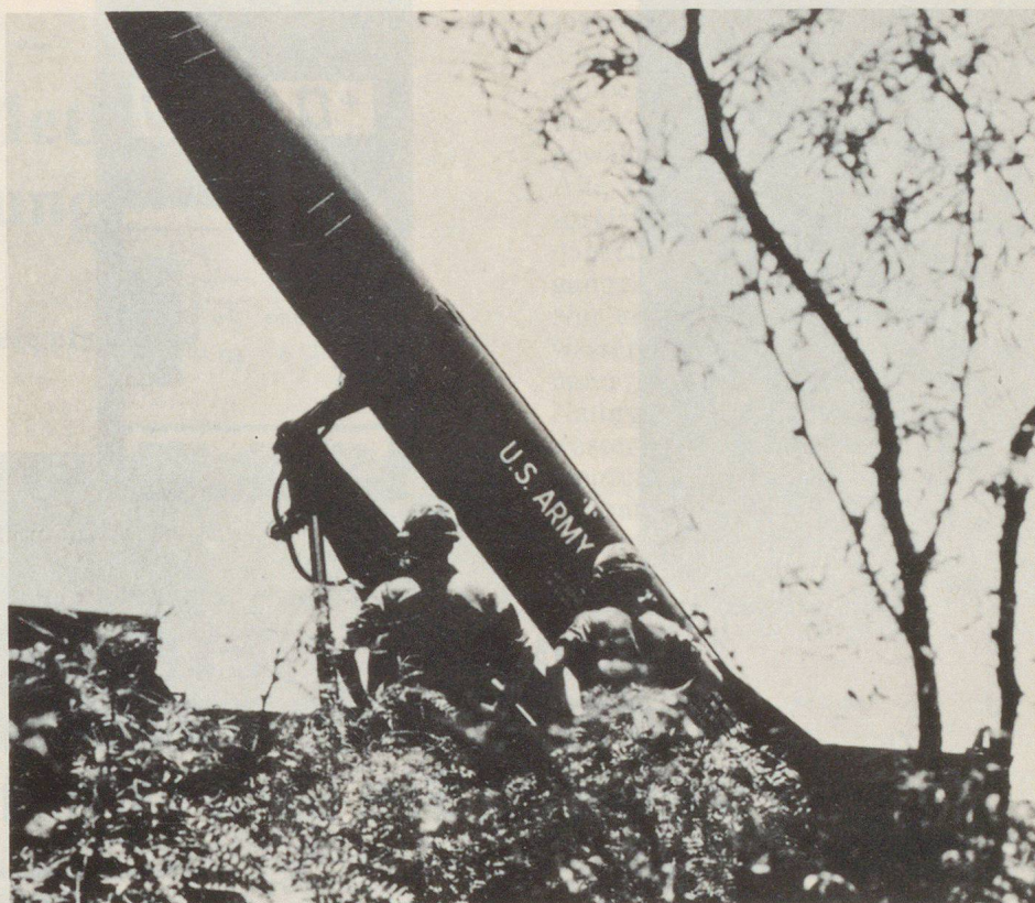
Abb. 3. Dieses amerikanische Raketensystem «Lance» wird in den Nato-Staaten seit 1973 eingesetzt. Die Reichweite liegt zwischen 8 und 120 km. «Lance» kann mit konventionellem oder nuklearem Sprengkopf verwendet werden; es ist für den Einsatz von Neutronenwaffen vorgesehen.
