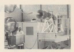
Innenansicht der EMP-Halle mit Stossstromgenerator 500 kV
