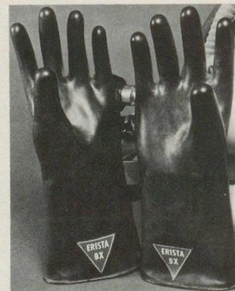
Konzentration 50 % nicht überschreiten. Die Summe der Beständigkeitswerte wird durch andere Polymere nicht erreicht. Erista-BX-Handschuhe sind in einem Temperaturbereich zwischen -40 °C und +120 °C einsetzbar, haben eine hohe Zerreißfestigkeit, wobei der sehr gute Weiterreisswiderstand hervorzuheben ist. Intensiver Kontakt zu Öl, Benzin und Fett sollte jedoch vermieden werden. Erista-BX-Handschuhe können auch als Überziehhandschuhe über einen weiteren Handschutz getragen werden.
