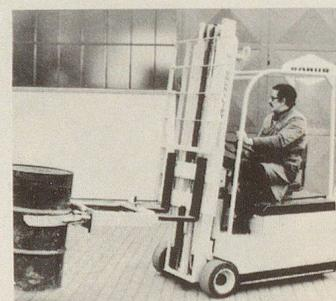
Neuer mechanischer Fassgreifer für schnelles und sicheres Verladen, Transportieren und Stapeln von Rollreifenvässern (FTA Fahrzeugtechnik AG, CH-5035 Unterentfelden)
