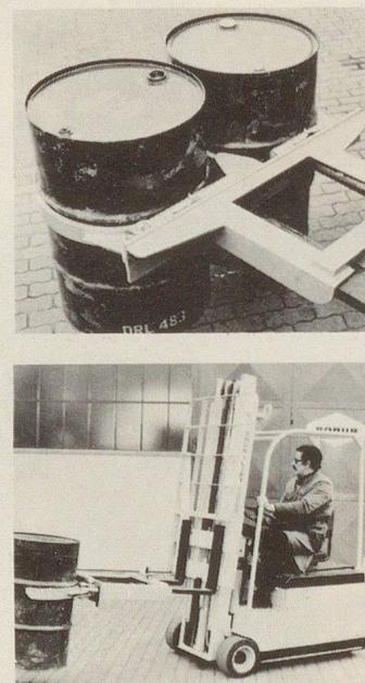
Neuer mechanischer Fassgreifer für schnelles und sicheres Verladen, Transportieren und Stapeln von Rollreifenvässern (FTA Fahrzeugtechnik AG, CH-5035 Unterentfelden)
