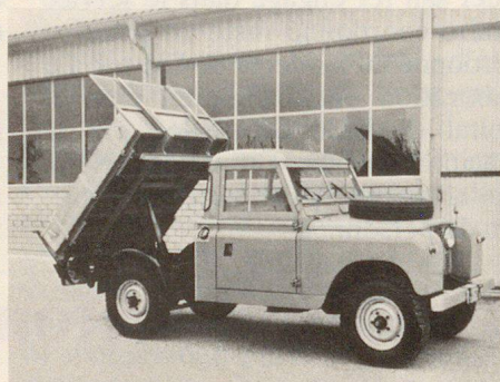
Génie civil: Land Rover 88 avec pont basculant
