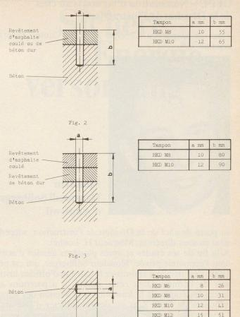
En montant les lits dans les constructions de protection, on les séparera par un espace de 5 cm de la paroi arrière. Les supports sont fixés au sol par des tampons compacts Hilti HKD 10 et des vis à 6 pans M 10 selon les instructions pour la pose des tampons compacts Hilti OFPC ci-jointes. Les fixations des supports au sol doivent être perforées de trous de 12 mm de diamètre.
