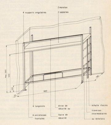
Pour la fabrication des supports et des longerons, des échelles, des étriers et des barres de sécurité, on utilisera des profilés en acier.
