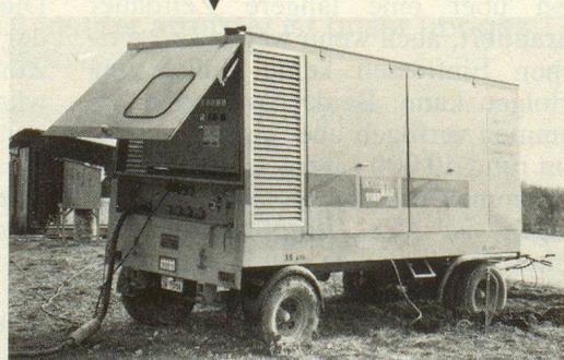
Standard-Programm transportabler und mobiler Generatorgruppen von 60–350 kVA, 50 Hz (größere Anlagen auf Anfrage)
