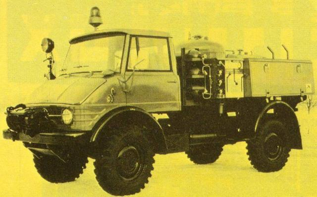
Trockenlöschfahrzeug. Nimmt bis zu 1000 kg Löschpulver mit.
