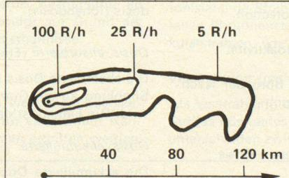
Erstellen der Verstrahlungskarte (Kurven gleicher Normdosisleistung)
