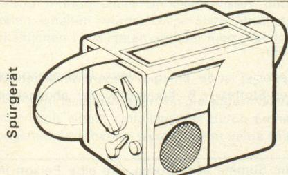
Messung der Dosisleistung über dem Erdboden mit Spürgeräten (Atomwarnposten, Spürtrupps)
