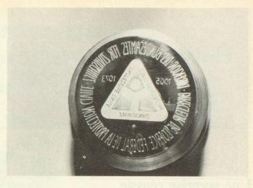
Zur Herstellung der Medaillen werden in der Presse die beiden Prägestempel in einem Führungsring «einander gegenübergestellt» (Abb. 6). Eine runde Scheibe von Silber oder Gold wird in den Führungsring gelegt, und die beiden Stempel werden mit 360 t Druck dagegen gepresst. In Abbildung 7 sind die ersten 6 Walter-König-Medaillen (in vorerst sehr prosaischer Umgebung) zu sehen.
