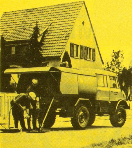
Unimog-Hochdruck-Kanalspüleinrichtung 1000-1200 m Tagesleistung.
