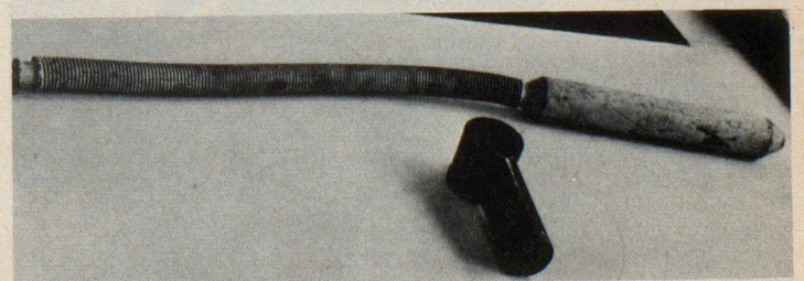
Fig. 9. Dispositif de silencieux de refoulement et d'aspiration
