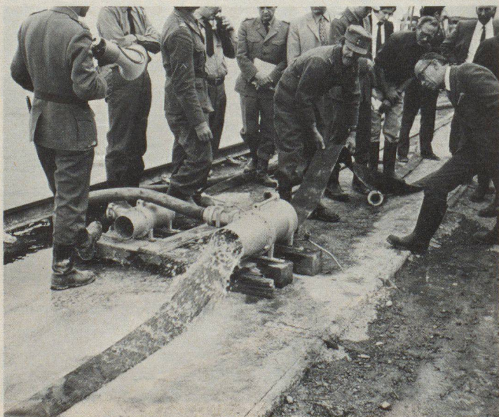
Fig. 17. Appareil lave-tuyau des troupes de protection aérienne
