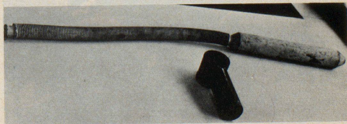
Fig. 9. Dispositif de silencieux de refoulement et d'aspiration
