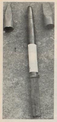
Abb. 18. Auswechselbare Spitzeisen
