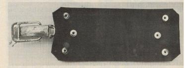
Abb. 40. Vulkollanbinde nach dem Gebrauch
