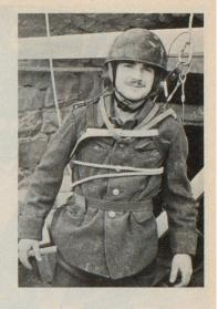
Ab.. 47 und 48 Seilrettungsgerät mit Gasschutztelefongarnitur
