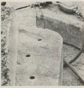
Abb. 26. Versuchsanordnung mit drei Löchern in «weichem» Beton
