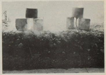
Abb. 49. Brandkörper mit pyrotechnischer Zündung
