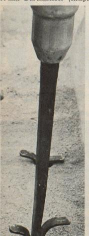
Abb. 27. Spaltbacken in Reihenbohrung
