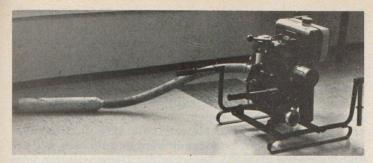
Abb. 10. Schalldämpfer an Motorspritze Typ 1 montiert
