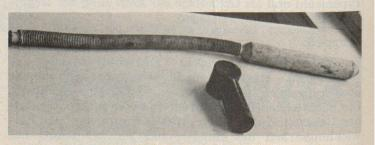
Abb. 9. Auspuff- und Ansaugschalldämpfeinrichtung
