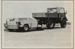
Unimog mit Strassenkehrmaschine
