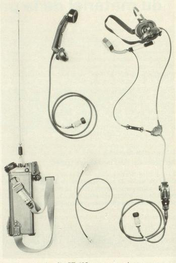
Fig. 3. Appareil radio SE-125 avec accessoires
