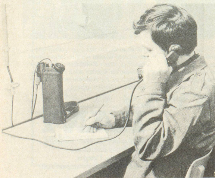
Das Bild zeigt den Einsatz des SE-125 mit Mikrotelefon in einer Anlage des Zivilschutzes
