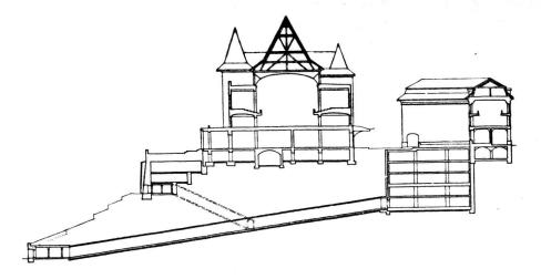
Osttrakt wurde total umgestaltet. Die zum Teil neue Unterkellerung enthält die Heizzentrale und weitere Maschinenräume. In den Obergeschossen wurden Büros und Verwaltungsräume auf die doppelte Fläche erweitert. Im Dachgeschoss stehen neue Büchermagazine zur Verfügung. Die Bücherausleihe wurde neu gestaltet. Alle bis hier beschriebenen Bauarbeiten umfassen die
