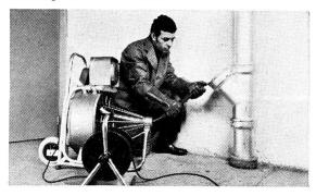
Entstopfer Typ A20 für Rohre von 50-300 mm Ø und bis zu 30 m Länge.
