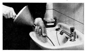
Entstopfer Typ D für Rohre von 15-50 mm Ø und bis zu 5 m Länge mit rostfreier Welle.
