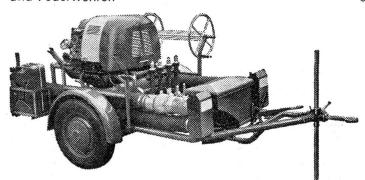
Typ 2 Höchstleistung bei 80 m GMF: zirka 1600 I/min Motor VW-Industrie, 44 PS bei 3600 T/min
