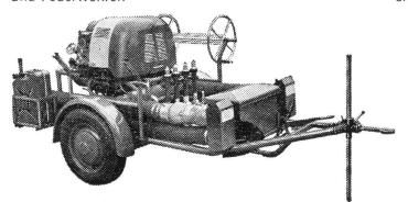
Typ 2 Höchstleistung bei 80 m GMF: zirka 1600 l/min Motor VW-Industrie, 44 PS bei 3600 T/min
