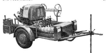
Höchstleistung bei 80 m GMF: zirka 1600 I/min Motor VW-Industrie, 44 PS bei 3600 T/min
