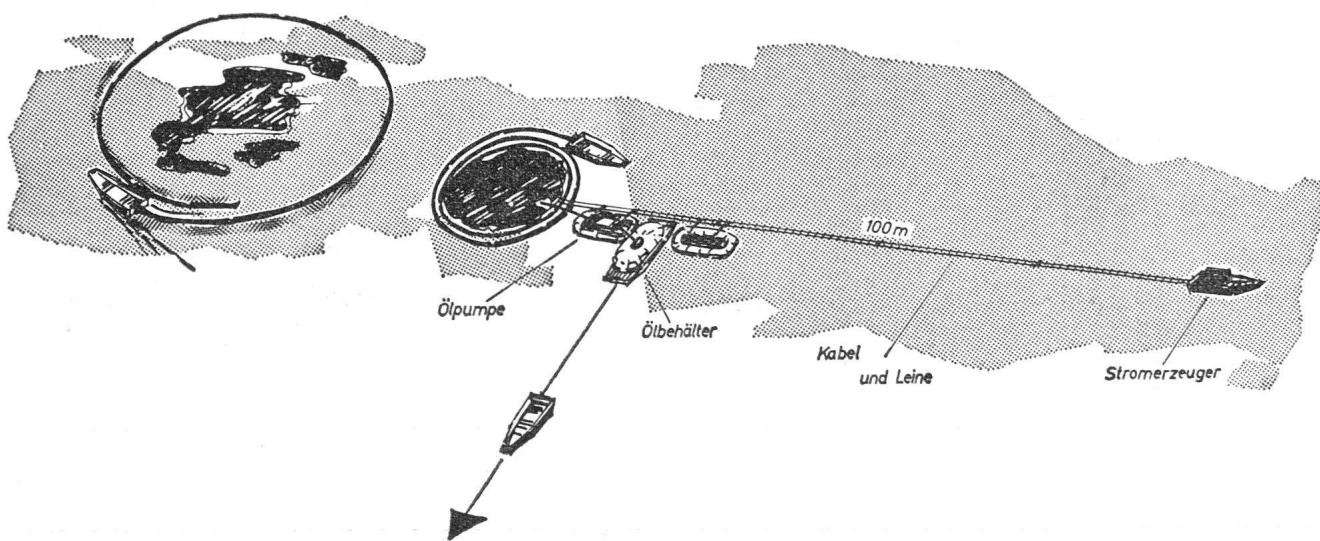
Zum Schemabild: Die Oelschnecke ist fertig. Ein zweites Motorboot, ein Boot der Staatlichen Feuerwehrschule Würzburg mit Jetantrieb, steht in Endstellung, 100 m von der Oelschnecke entfernt. Dieses Motorboot hat eine Leine und ein Kabel gezogen, getragen von einem Schwimmschlauch. Es ist zugleich eine Art Schleppanker gegen Abdrift und trägt
