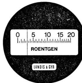
Skala im Dosimeter mit einem Messbereich von 0—20 Roentgen
