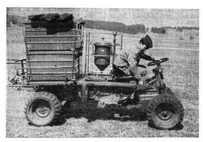
BERKEFELD -Trinkwasseraufbereiter AQUA-SERVER, 2 m³/h, aufmontiert auf kraka, konnte bei dem Fallschirmabwurf in Altenstadt am 28./29. März 1968 unmittelbar nach der Landung in voller Funktion eingesetzt werden
