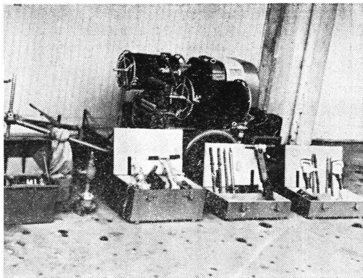
Hier das vollständig ausgerüstete Gerät mit zweimal 20 m Luftdruckschläuchen auf zwei Haspeln, zwei Kisten für pneumatische Werkzeuge, zwei Benzinkanistern und einer Werkzeugkiste
