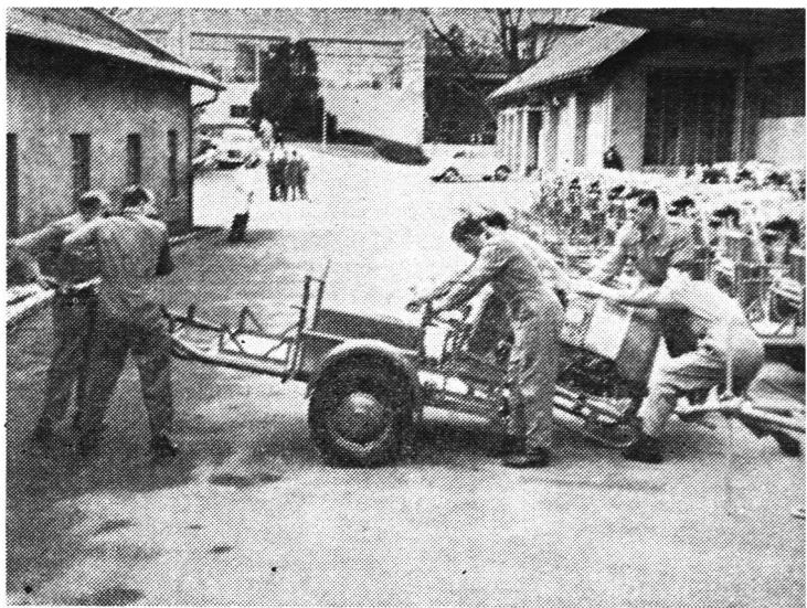
Auf Hochglanz poliert die ersten zur Ablieferung gelangenden Kompressoren. Wichtig ist die Forderung, dass die Sicherheit des Betriebes bei 20 Minusgraden oder bei 40 Grad über Null noch gewährleistet sein muss.
