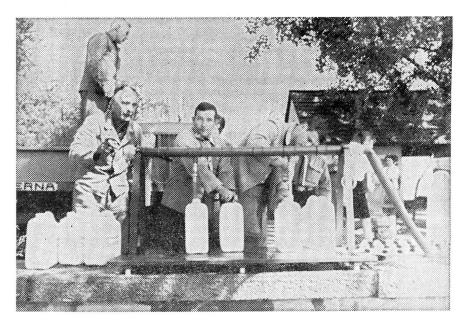
Aus dem Reinwasserbehälter gelangt das Trinkwasser in die Abfüllanlage und wird in die Einheitskanister abgefüllt.
