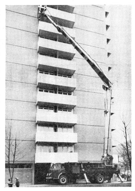
Die abgebildete Simon-Hebebühne hat ein Gesamtgewicht (inkl. Fahrzeug) von ca. 13 t. Sie kann grundsätzlich auf jedes Lastwagenchassis aufgebaut werden, das einen Radstand ab 4800 mm aufweist und für ein Gesamtgewicht von 15 bis 16 t
