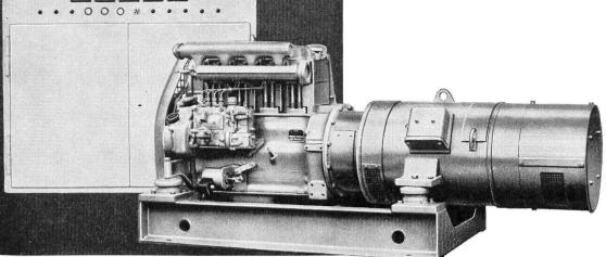
24 KVA, 3 x 380 V, 50 Hz, mit Dieselmotor Leistungsbereich: ab 600 W, nach oben unbeschränkt Siemens Elektrizitätserzeugnisse AG 8021 Zürich, Telefon 051/25 36 00 1002 Lausanne, Téléphone 021/22 06 75
