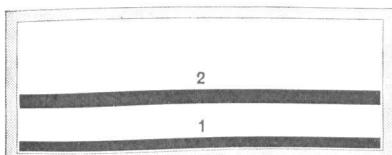
Erstellen des armierten Schutzraumbodens (1). Betonieren der Schutzraumdecke über neuem Boden (2).
