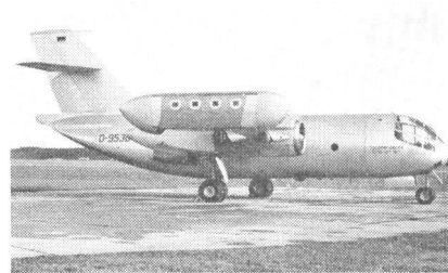
Zu senkrechtstartenden Kampfflugzeugen gehören auch Transporter mit ähnlichen Flugeigenschaften zur Versorgung. Hier die Do 31 mit Schwenkdüsentriebwerken in den Gondeln und Hubtriebwerken an den Flügelspitzen. Werksphoto Dornier
