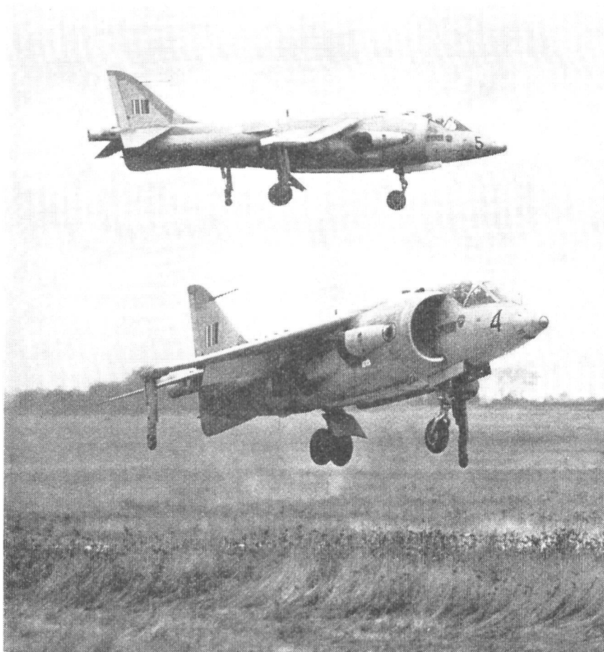
Der erste Senkrechtstarter der Welt, Hawker P 1127 «Kestrel», wird in einer gemischten englisch-deutsch-amerikanischen Versuchsstaffel erprobt. Die vordere Maschine im Schwebeflug kurz vor der Landung. Werksphoto Hawker Siddeley
