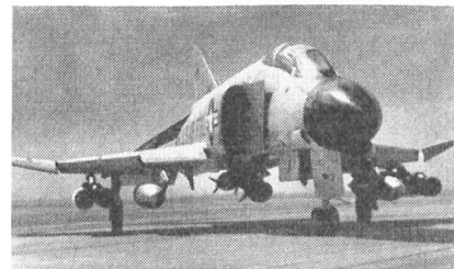
Der modernste im Dienst befindliche Jagdbomber der USA, F4C «Phantom II», konventionell bewaffnet mit Brisanzbomben unter dem Rumpf, Napalmbomben an den inneren und Säten ungelenkter Raketen an den äusseren Flügelpylonen.
