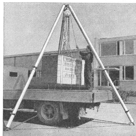
◀◀ «Meili-Deckenstütze» ganz aus Stahl (Patent), ist feuerfest, kann jederzeit durch Anwesende nachgespannt werden und fällt nicht um. Keine andere Metall- oder Holzstütze bietet dieselbe grosse Sicherheit. Je nach dem verwendeten Rohr kann die Tragfähigkeit 50 t überschreiten. EMPA-Attest verlangen.
