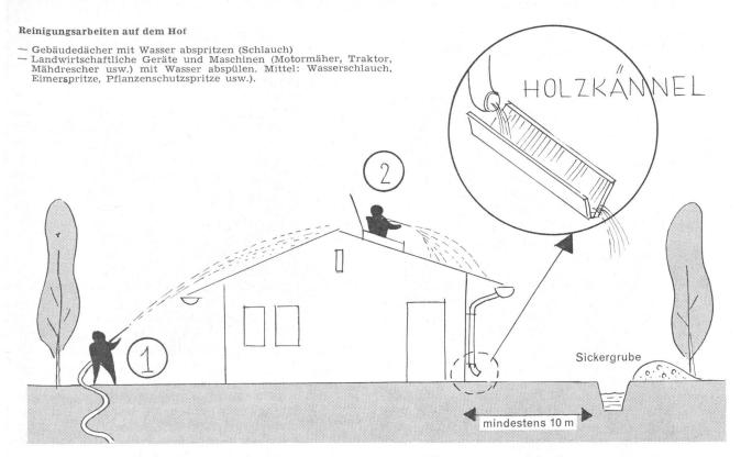
Falsch! Abspritzen von unten noch oben schwemmt den radioaktiven Staub unter die Dachziegel.
