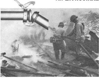
aus blankgeglühtem Kaltbandstahl mit einer Festigkeit von etwa 40-50 kg/mm². Rohrlängen 6 m, in feuerverzinkter Ausführung, gemäss den eidg. Vorschriften der Abteilung für Luftschutz.
