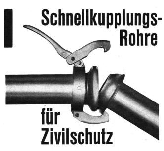
aus blankgeglühtem Kaltbandstahl mit einer Festigkeit von etwa 40-50 kg/mm². Rohrlängen 6 m, in feuerverzinkter Ausführung, gemäss den eidg. Vorschriften der Abteilung für Luftschutz.
