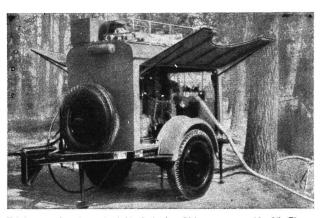
Trinkwasserbereiter mit elektrolytischer Chlorerzeugung 10 m³/h. Eingeführt zur Truppenwasserversorgung und zum Bevölkerungsschutz in vielen Ländern.
