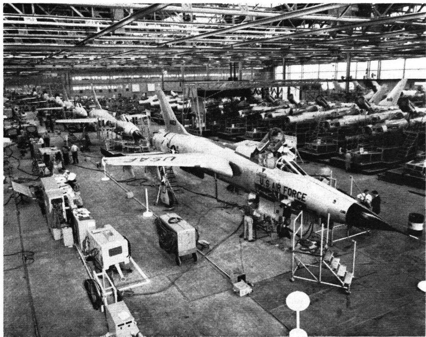
In der Montagehalle der Firma Republic, wo die F-105 in Serien hergestellt werden. Die Grössenverhältnisse sind gut erkennbar.
