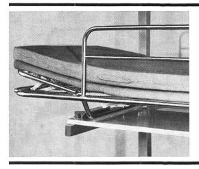
Vier abhebbare Liegerahmen, Grösse 190 × 75 cm, mit Spiralfederbespannung und verstellbarem Keil. Die Liegerahmen können fusswärts und seitwärts verschoben werden, so dass ein müheloses Abheben des belasteten Liegerahmens gewährleistet ist. Die oberen zwei Rahmen sind von 140 cm auf 110 cm absenkbar. Die unteren Liegerahmen befinden sich 50 cm ab Boden. Die Ausführung des Kurbelbettes entspricht dem Pflichtenheft des Bundesamtes für Zivilschutz.
