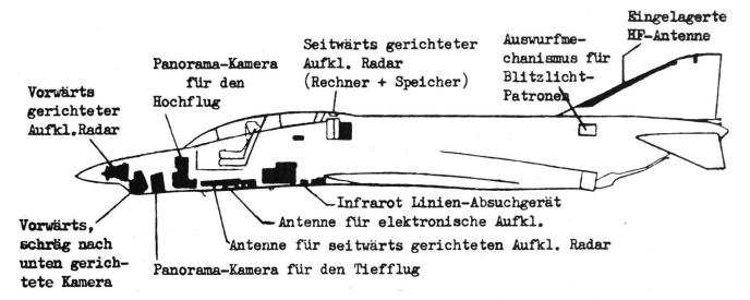
RF-4C der Firma McDonnel. Der Schnitt durch dieses moderne amerikanische Aufklärungsflugzeug zeigt eine typische Ausrüstungsvariante.
