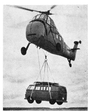
Hubschrauber-Verlastung eines fahrbaren Trinkwasserbereiters (VW-Kombi)
